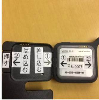
端末を裏向けて①を目印に充電アダプタにセットします
